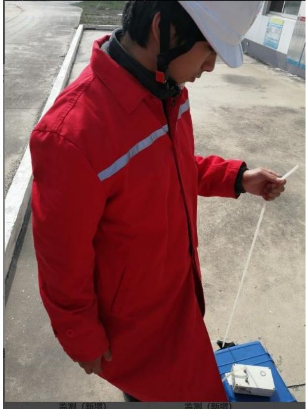
厂内无组织废气采样↑
