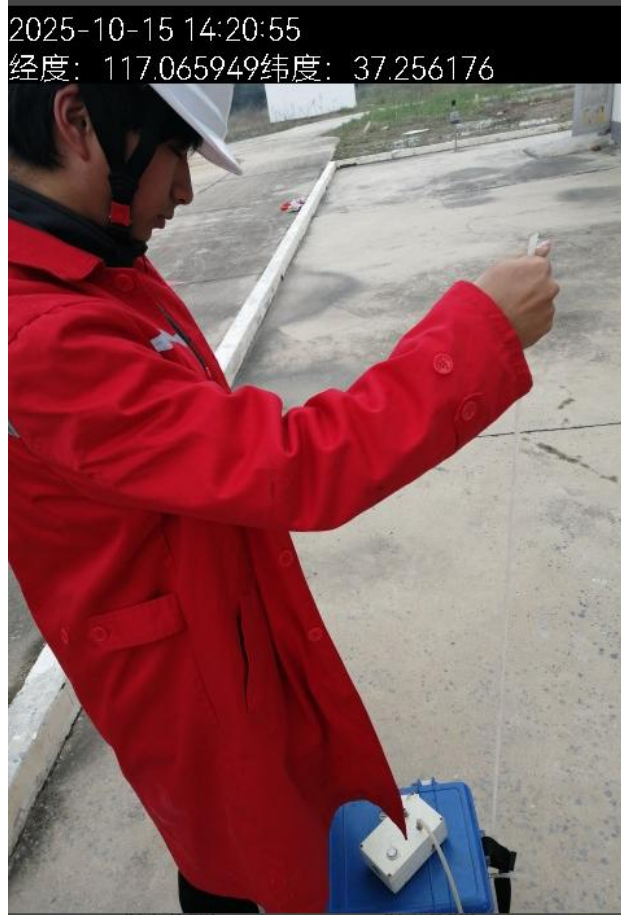
厂内无组织废气采样 ↑
